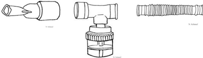
Ponga la pieza T encima del recipiente del nebulizador. Conecte la boquilla en una punta de la pieza T y el tubo corrugado en el otro extremo de la pieza T.
